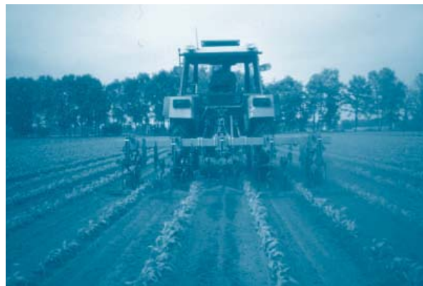
Volledig mechanische onkruidbestrijding in maïs mogelijk met eggen gevolgd door anaardend schoffelen
