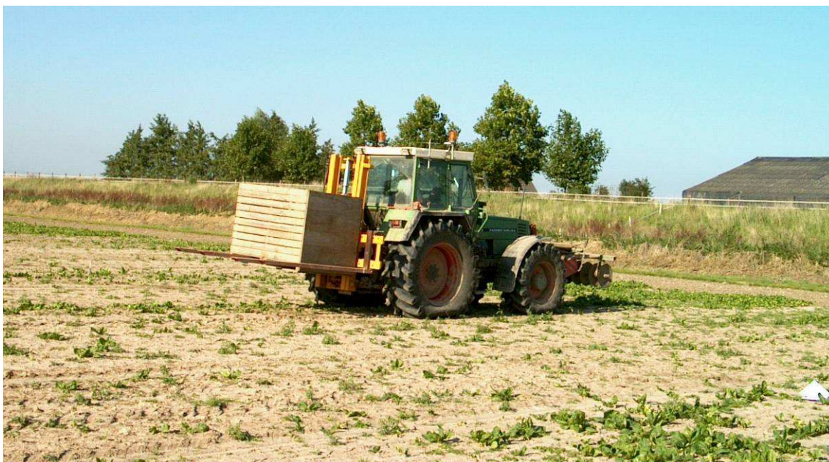
Figuur 2 Het aanrijden van de veldjes met verschillende bodemdrukken.
