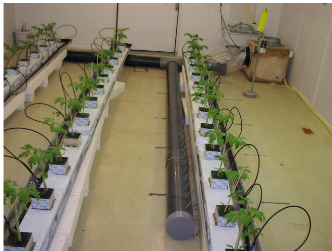
Figuur 14 Inrichting van de klimaatcel met planten en luchtverdeelsysteem
