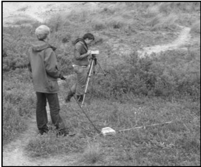
Afbeelding 4: Tim en Marjon meten de lichtintensiteit met het SunScan Canopy Analysis System.
