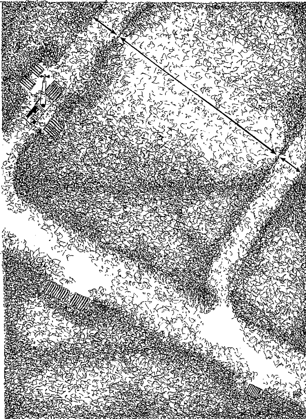
Tekening nr. 1. Forwarder-dunning-sortimentenmethode. Perceelontsluiting door middel van evenwijdig aan elkaar lopende trekkerpaadjes.
