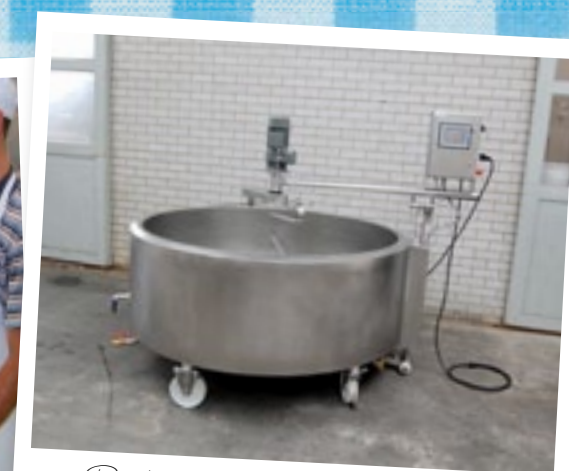
Rvs kaasbak uit met PLC uit 2011.
