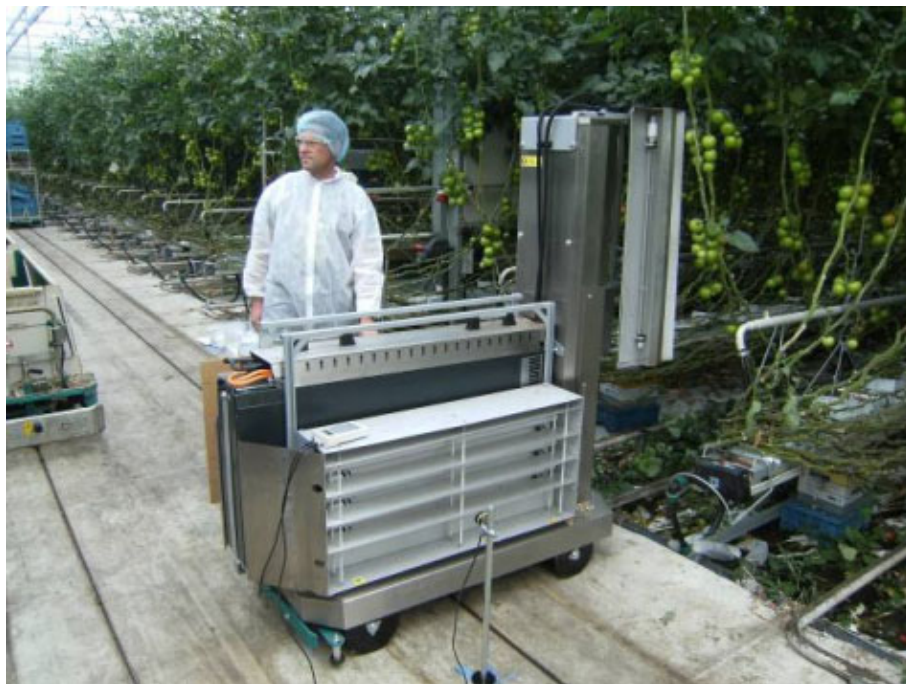
Figuur 1. UV-robot met aan de voorkant 2 verticale UV-C lampen (35 Watt) aan elke zijkant vier UV-C lampen (75 Watt).
