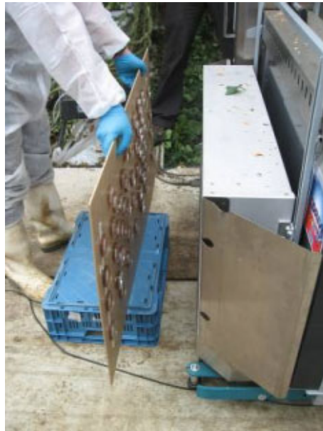
Figuur 3. Opstelling van jonge Botrytis cultures voor de UV-robot bij verschillende UV-doseringen.
