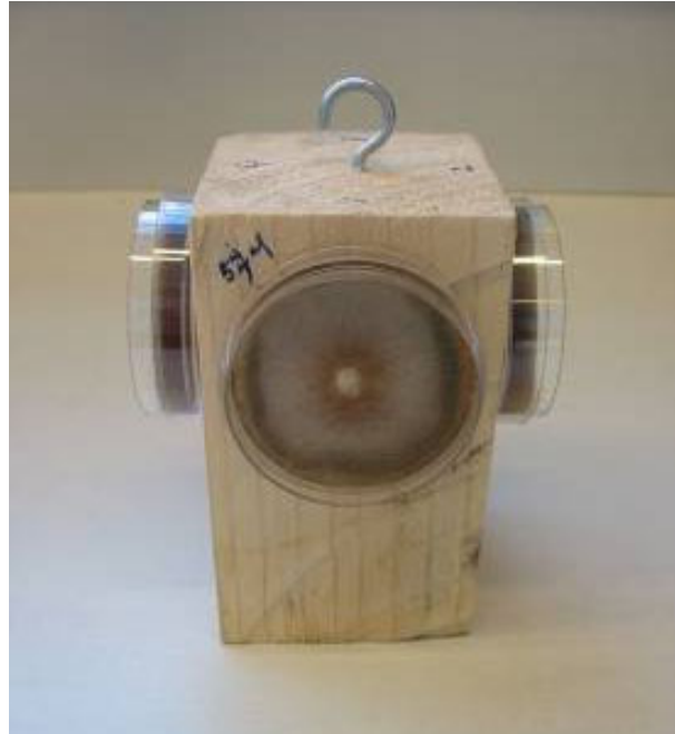
Figuur 2. Houten meetbox met vier voedingsbodems met jonge sporulerende Botrytiskolonies om het effect van UV-C in het gewas te bepalen.
