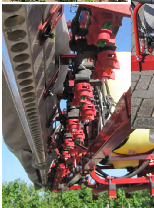
Figuur 2. Lechler VarioSelect dophouders, spuitdoppen in VarioSelect dophouder en GreenSeeker sensor op SensiSpray Horti.
