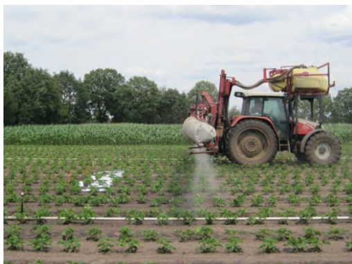
Figuur 1. Standaard luchtondersteunde veldspuit zoals gebruikt in depositiemetingen in aardbei.
