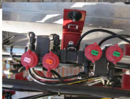
Figuur 2. Lechler VarioSelect dophouders, spuitdoppen in VarioSelect dophouder en GreenSeeker sensor op SensiSpray Horti.
