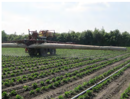
Figuur 1. Standaard luchtondersteunde veldspuit zoals gebruikt in depositiemetingen in aardbei.
