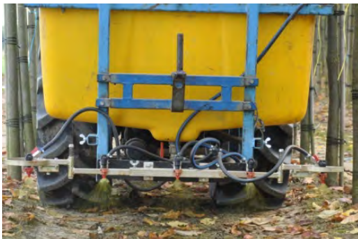
Figuur 2.1. Spuitboom onkruidspuit (links) met 5 spuitdoppen en onkruidspuit voorzien van spuitkappen (rechts), de kappenspuit.
