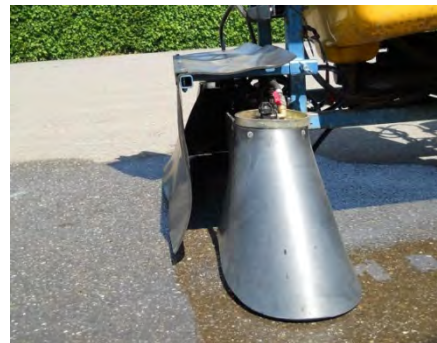
Figuur 2.1. Spuitboom onkruidspuit (links) met 5 spuitdoppen en onkruidspuit voorzien van spuitkappen (rechts), de kappenspuit.
