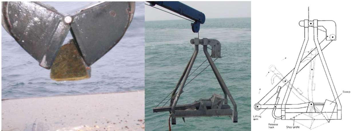
Figuur 12. Waar een Van Veen happer in een gebied met keien snel geblokkeerd raakt (links) en daardoor de vangst verspeelt, is een Hamon happer (midden) speciaal ontworpen voor dergelijke substraten. Dit apparaat heeft een bak welke bij bodemcontact middels een hefboom met een cirkelvormige beweging door de bodem graaft, tegen de klep aan. Op de figuur in het midden is het apparaat in open stand (hefboom neer, de bak staat verticaal op de bodem). In het schema rechts (Eleftheriou en Holme 1984) wordt geïllustreerd hoe de hefboom omhoog scharniert en daarbij de bak in de bodem duwt, tot een horizontale positie tegen de klep aan.
