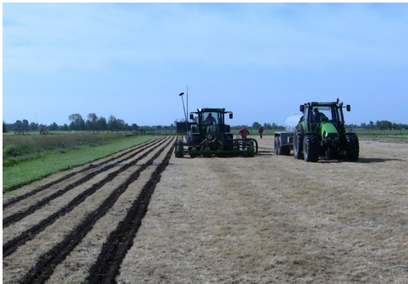
Figuur 2. Inzaai van snijmaïs met een zogenaamde strokenfreesmachine gecombineerd met het toedienen van organische mest
