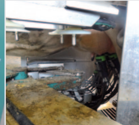
De 3D-camera (onder de zwarte kunstof plaat) vindt de spenen gemakkelijk.
