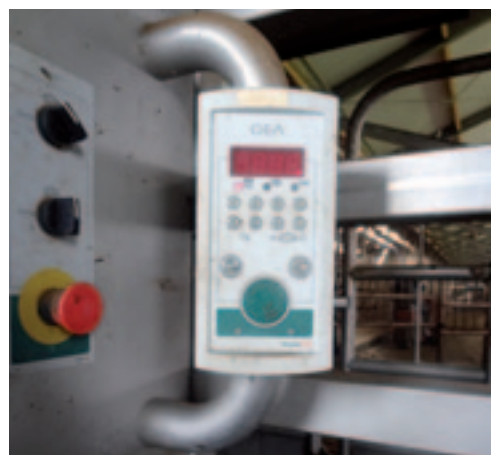
Elke stand is zelf voorzien van een fysieke melkmeter.
