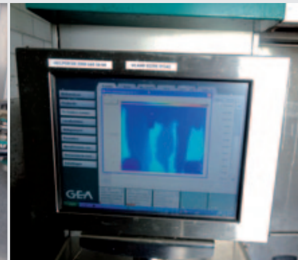
Op het bedieningsscherm is goed te zien wat de camera op de arm ziet.
