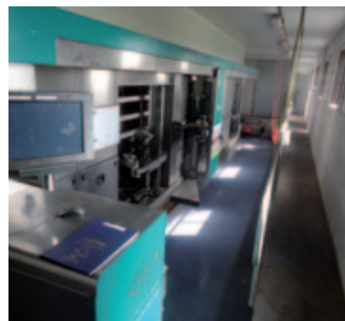
Door de verdiepte melkput (optie) is het gemakkelijk om handmatig een koe aan te sluiten of een koe te behandelen.
