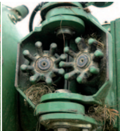
De vingerkoppeling (hier van Krone) houdt altijd contact, ook met de armen opgevouwen.
