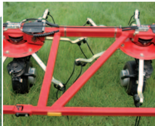
Fella haalt sterkte uit een subframe. De koker met de aandrijving kan daardoor licht zijn.
