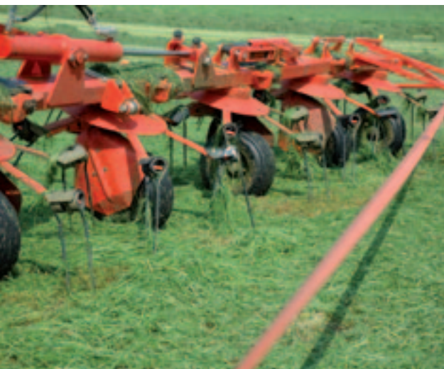
Kuhn houdt de arm in positie met een spanriem. Dat bespaart gewicht.
