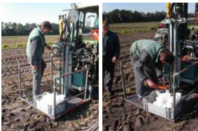
Foto 1. Bemonstering van het bodemprofiel tot 1 m op Vredepeel met behulp van hydraulisch aangedreven gutsboor (Foto's H.A.G. Verstegen, Vredepeel).
