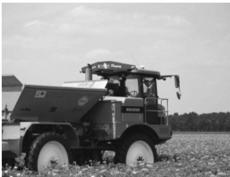
Figuur 6. N-sensor gewasreflectiemeter op dak van cabine.
