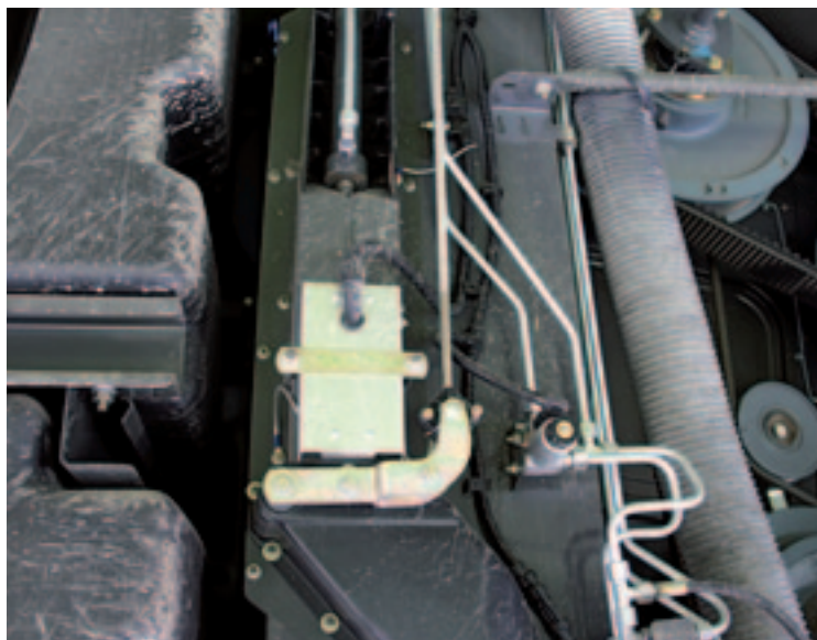
▲ Detail van de opbrengstmeting. Vanuit de jakobsladder wordt een klein bakje gevuld met graan. Deze lost automatisch terug in het kanaal als die vol is.
