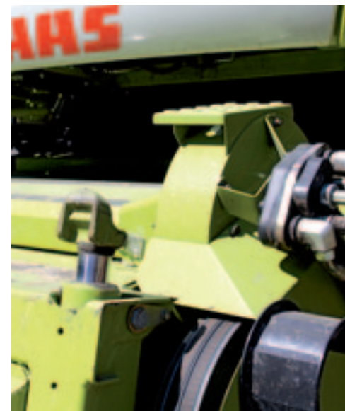
▲ Een grappige vinding van Claas. Stofafzuiging op het invoerkanal. Het scheelt voornamelijk veel poetsen van de voorruit.
