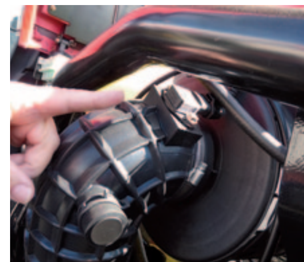
De vochtsensor meet de luchtvochtigheid. Bij droge lucht wordt meer AdBlue ingespoten.
