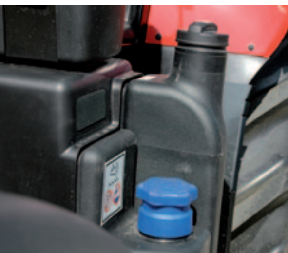
Om bij tanken vergissingen te voorkomen is de AdBlue-tank voorzien van een blauwe dop.
