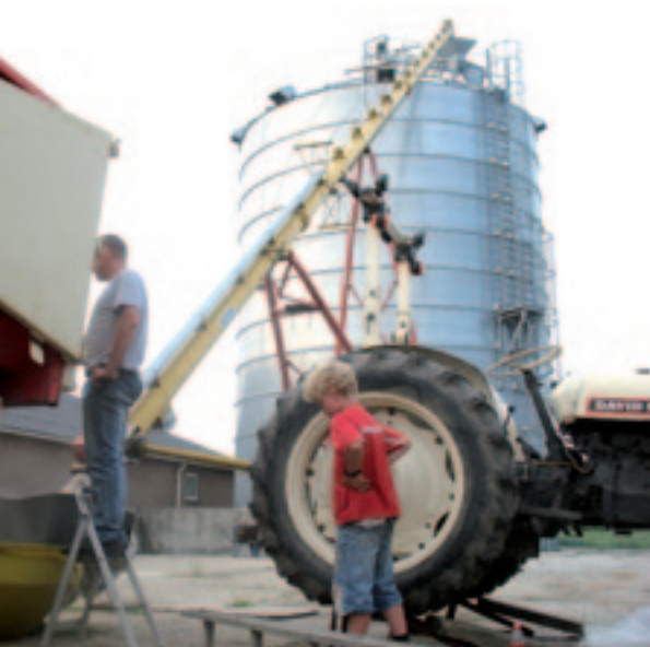
▲ Veel telers kiezen voor een verticale ketting-elevator, die tegen de silo wordt aangebouwd. Maar een losse vijzel werkt natuurlijk ook.
