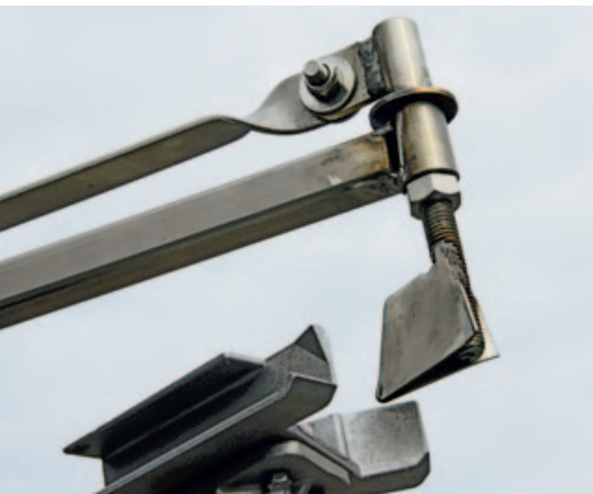
▲ Om perceelshoeken te beregenen, monteren veel fabrikanten een straalbreker die in de waterstraal kan zakken. Deze wig verandert het sproeibeeld van het kanon. Voor de aansturing van de straalbreker hebben specialisten verschillende oplossingen bedacht.
