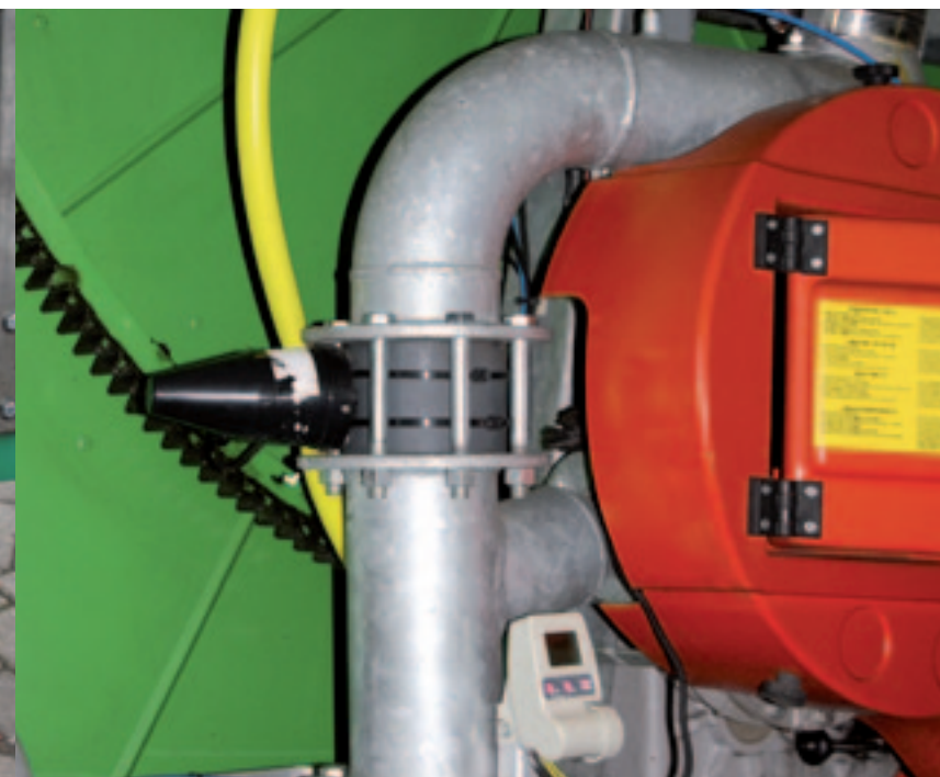
▲ Smits heeft op de haspel een kleine sproeier gemonteerd die de sector rondom de haspel van water voorziet. Een simpele tijdklok sluit de (zwarte) klep op het moment dat er voldoende water is toegediend.
