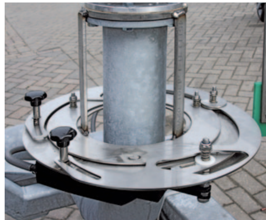
▲ Bij een onregelmatige perceelsgrens, is de werpwijdte naar de zijkanten te begrenzen met in- en uitschuifbare schijfsegmenten. Ook daarmee komt de straalbreker weer in de waterstraal terecht en wordt de werpwijdte beperkt en de zwenksnelheid vergroot.
