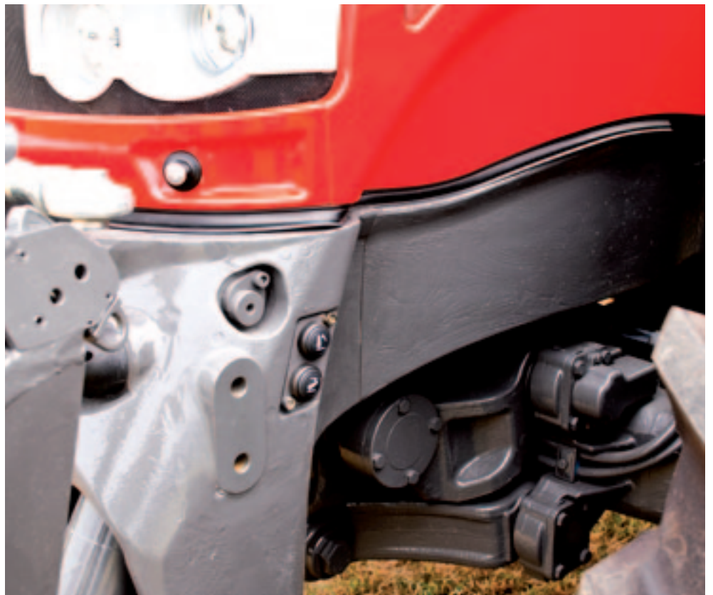
▲ Massey Ferguson heeft met de 6600-serie een compacte wendbare trekker willen maken met veel vermogen. Behalve de keuze voor een viercilinder, is dat goed te zien aan het chassis bij de voorwielen.
