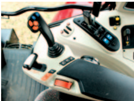
▲ Transmissie, handgas en de multifunctionele joystick zitten in de armleuning.
