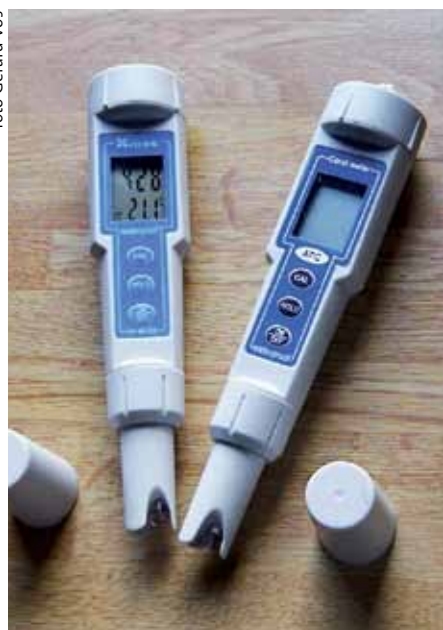
Een pH-meter (l) en een geleidbaarheidsmeter (r)
