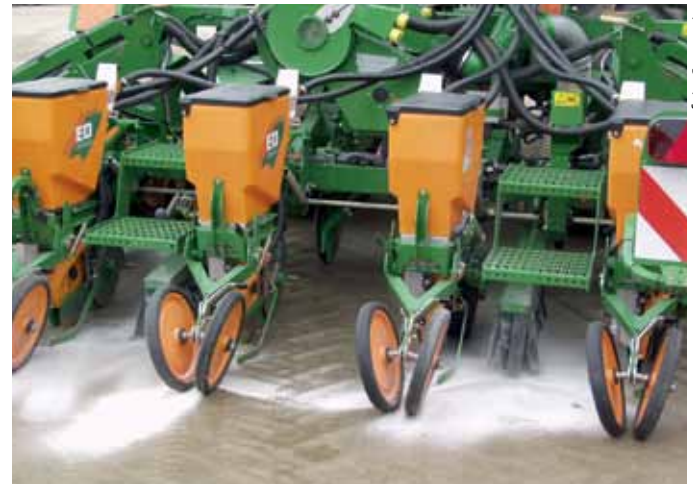
Zaaimachine; tussen het eerste en tweede wielstel van rechts de uitmonding van een zgn. stofdeflector
