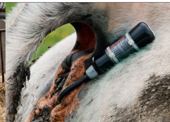
Temperatuursensor is naast de staart bevestigd
