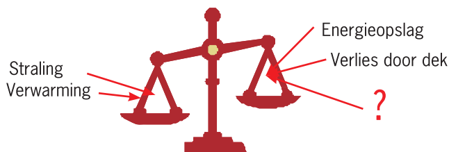
Figuur 1. De energiebalans voor een kas. In dit geval wordt de ventilatie onbekend verondersteld.
