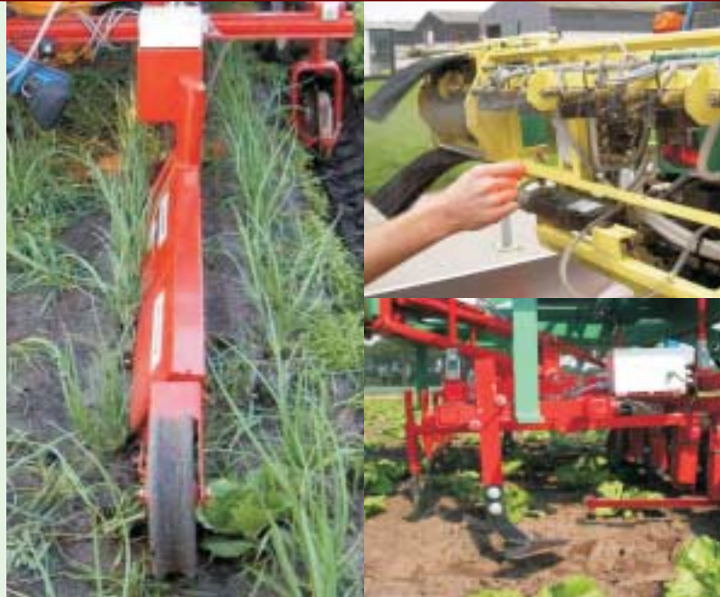
Gewasplantherkenning door middel van beeldverwerking (Poulsen, links), op basis van fluorescentie (Weed-It, rechtsboven) en op basis van lichtsluizen (Sarl Radis, rechtsonder).
