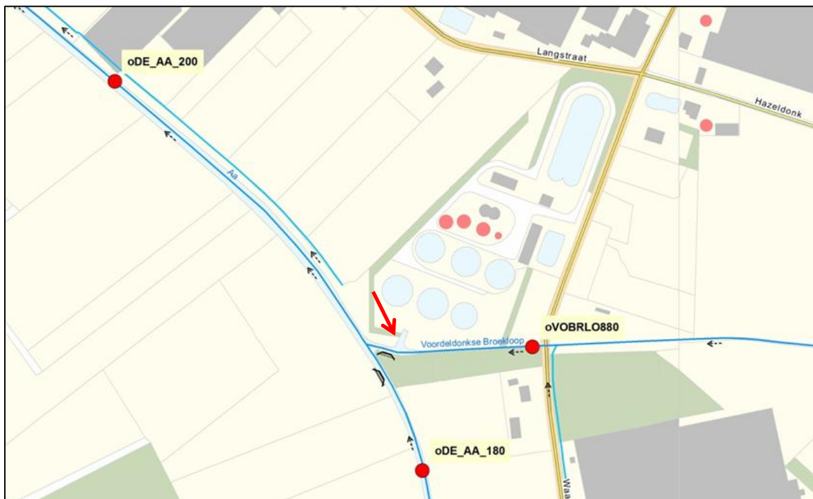
Figuur 1: Ligging meetpunten ten opzichte van rwzi Asten in resp. de Aa en Voordeldonkse Broekloop. Rode pijl geeft lozingspunt van het effluent weer.
