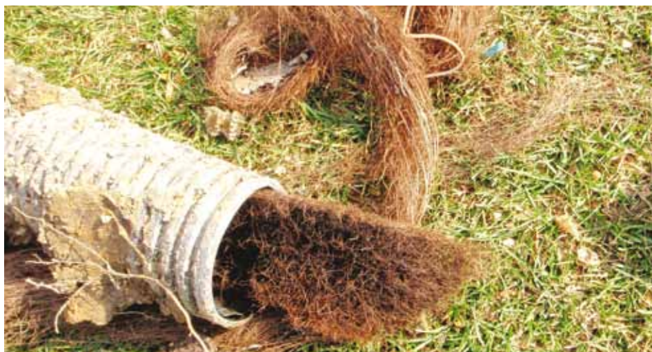
Op een golfbaan vormen boomwortels die een geperforeerde buis verstoppen, een veelvoorkomende oorzaak van mislukte drainage, vooral op locaties waar wilgen, populieren en andere ondiep gewortelde bomen zijn geplant.
