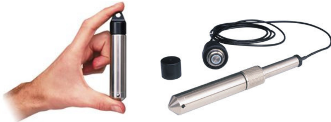
Figuur 2. De DIVER-drukopnemer van Van Essen Instruments (links) kan uitgerust worden met een data-kabel (rechts) om een eenvoudige uitlezing van gegevens via een veldcomputer mogelijk te maken.
