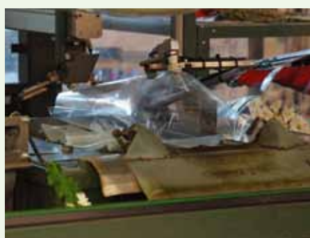
de inhoesmachine blaast de hoezen op...
