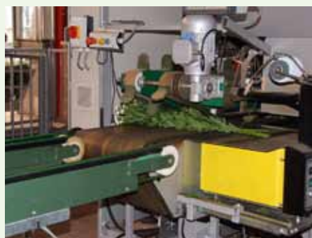
een bosmachine bindt de bossen automatisch...
