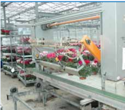
Een robotarm met grijper pakt een hele rij potjes van de rolcontainer en zet deze op de lopende band, waar ze eerst worden gesorteerd.
