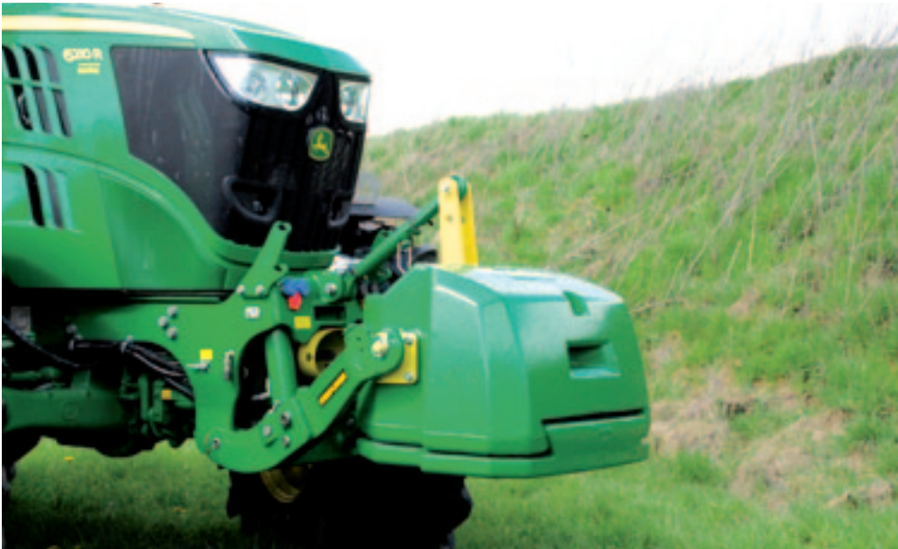
▲ De fronthef maakt het 'spelen' met gewicht (en daarmee de zoektocht naar het optimum) een stuk makkelijker. Het onderste deel van dit gewicht is naar wens nog weer aan of af te schuiven. Dat is een heel ander verhaal dan handmatig sjoer- en schroefwerk met gewichten van 45 kg.
