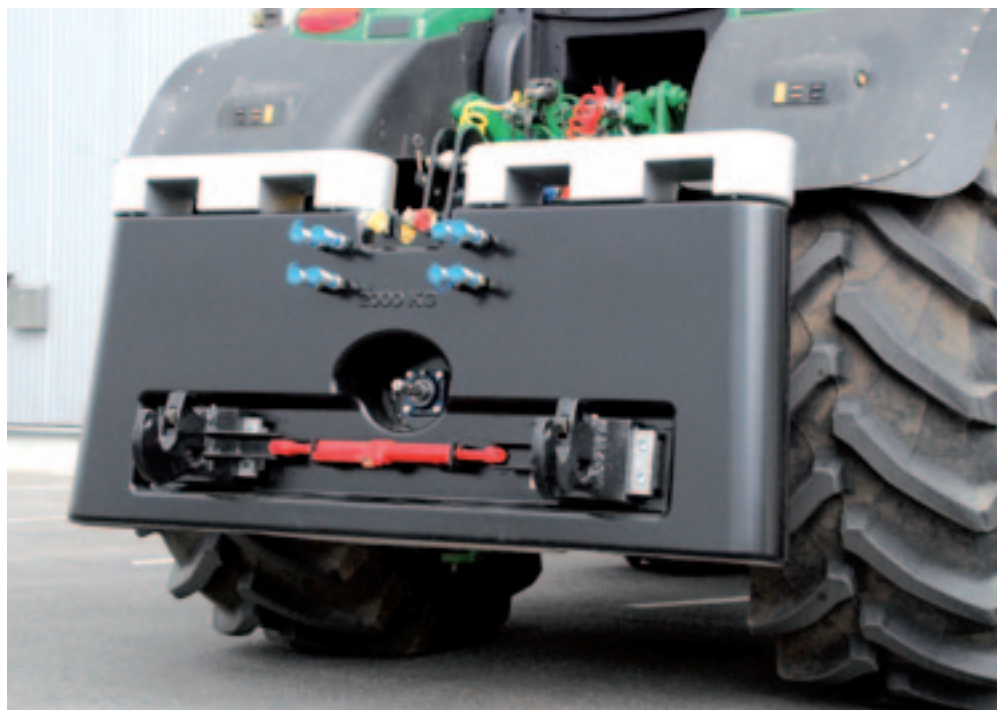
▲ Het Pick-up gewicht van Pateer biedt een goede mogelijkheid om bij getrokken en halfgedragen werktuigen extra gewicht en daarmee trekkracht over te brengen op de achteras van de trekker. Het basisgewicht weegt 2.000 kg, is 209 cm breed en 22 cm diep. Het kost exclusief btw 3.000 euro af-fabriek.
