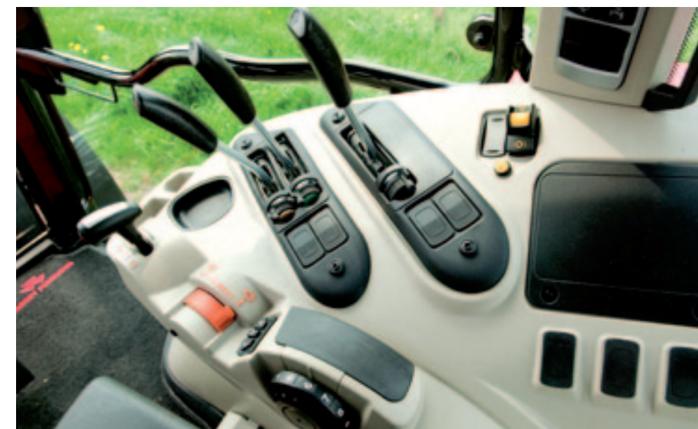
▲ Het rechterzijconsole van de Massey Ferguson 5610 komt uitermate bekend voor. Het T-hendeltje bedient de versnellingsbak. Er zijn drie mechanisch bediende hydraulische ventielen.
