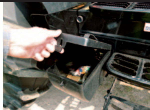
▲ Handig. Het gereedschapstijl is aan de rechterkant naast de trap opgeborgen en te openen zonder hem helemaal te verwijderen.
