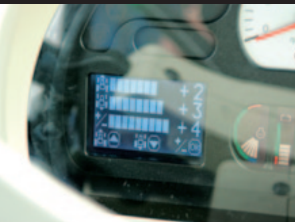
▲ Met een paar drukknoppen en een display kun je onder meer de mate van aangrijpen van de versnellingsbak instellen.
