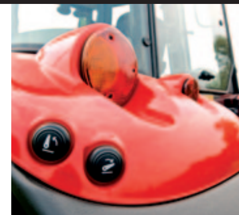
▲ Naast de hef kun je ook de aftakas op de spatborden bedienen. De aftakas kan met een van tevoren ingesteld toerental draaien.
