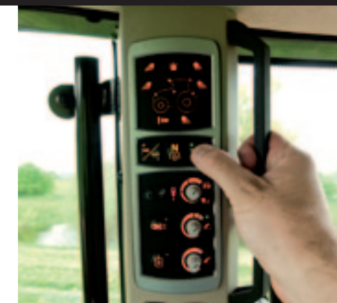
▲ Druk- en draaiknoppen voor verlichting, hef en aftakasinstellingen zijn op de rechtercabinestijl te vinden.
