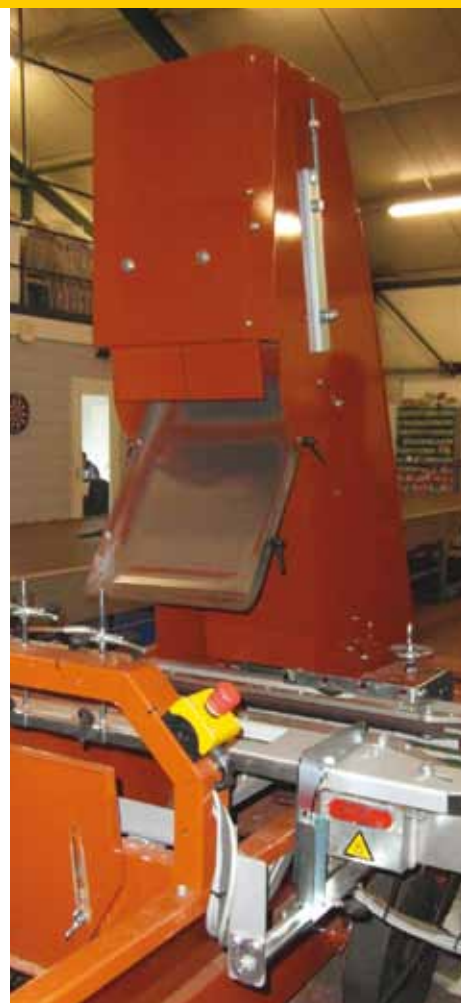
Afstrooien met bestaande potmachines.
