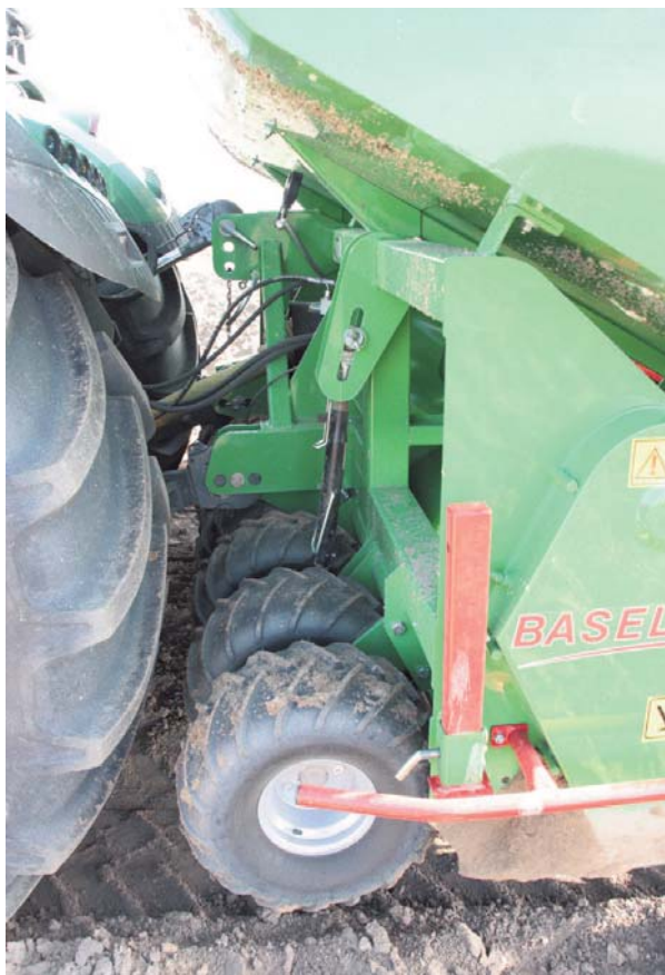
De Baselier-Wifo pootmachine loopt op lagedrukbandjes. Deze regelen tevens de diepte van de frees.
