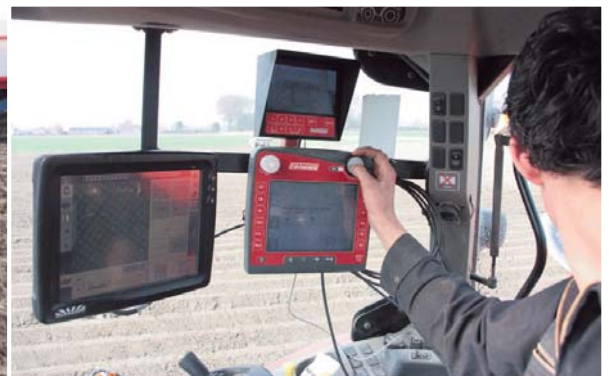
In de cabine van de trekker hangen de GPS-kast van de trekker en de bediening en GPS-kast van de Grimme-pootmachine.
