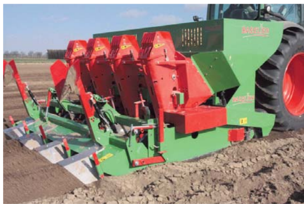
De pootmachine is, goed beschouwd, andersom op de frees geplaatst. Baselier kiest voor dit systeem om de machine compact te houden en om een betere verdeling van het gewicht van de machine te krijgen.
