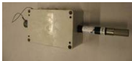
De Rotronic sensor voor temperatuur en relatieve luchtvochtigheid
