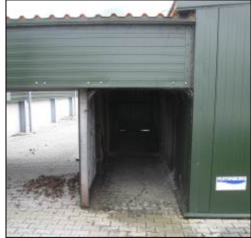
Warmtewisselaar aangepast voor de metingen. De lucht wordt i.p.v. recht omhoog, nu via de buizen in een uitstroomgang gebracht met als doel de luchtsnelheid te verlagen
