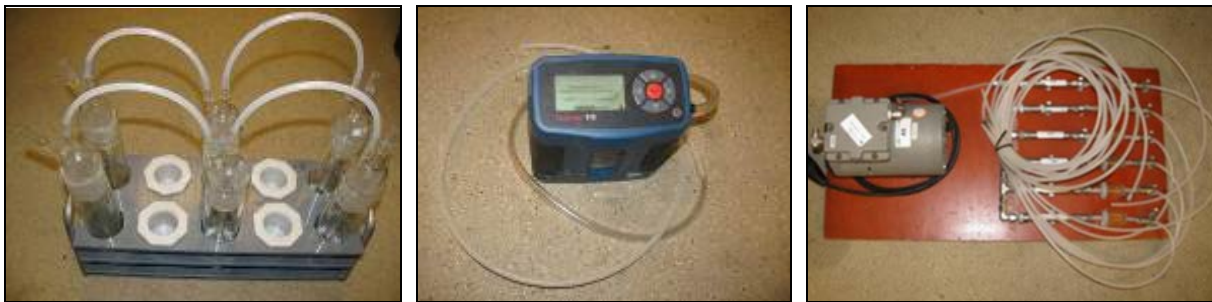
Meetopstelling nat-chemische methode voor ammoniakemissiemetingen. Links: impingers. Midden: Flowmeter. Rechts: pomp
