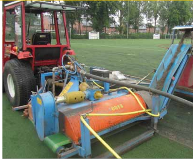
Verwijderen van zand en rubber.
