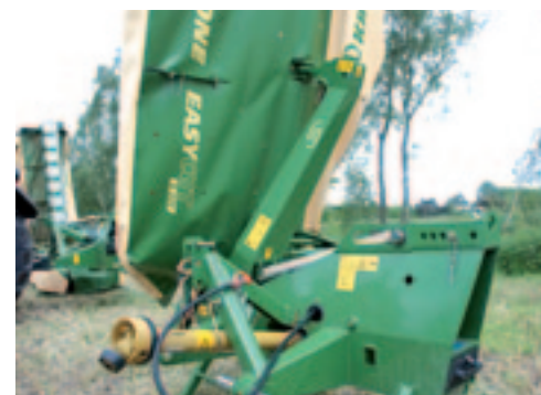
Krone levert bij de gedragen R-serie vier steunpoten om de maaier opgeklapt weg te zetten.
