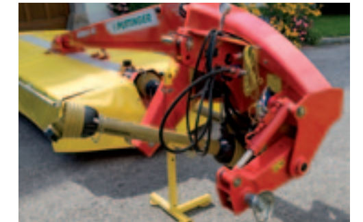
Een beweegbare arm van de bok van de maaier, zorgt dat de bok recht achter de trekker hangt.
