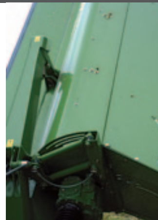
Een parallellogram dwingt de maaibalk omhoog bij een aanvaring.
