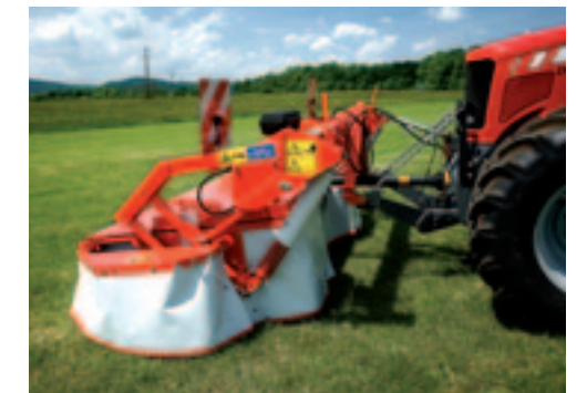
Voor een groot zwenkbereik hangen Kuhn en Fella de maaibalk aan de uiteinden op.
