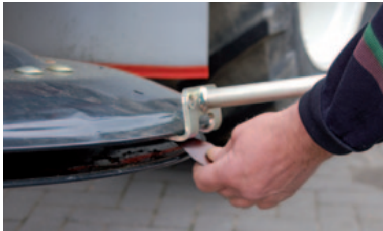
De PZ-trommelmaaier van Kuhn komt uit Geldrop en heeft net zoals de eerste machines uit de jaren zestig een vorkhefboom om de mesjes te vervangen. Daarmee kan weinig misgaan. De hefboom drukt de veerplaat (die één geheel vormt met de mespen) naar beneden. Een mesje voor de Kuhn PZ kost 1,04 euro. De Kuhn PZ trommelmaaier is ook als Deutz-Fahr op de markt.
