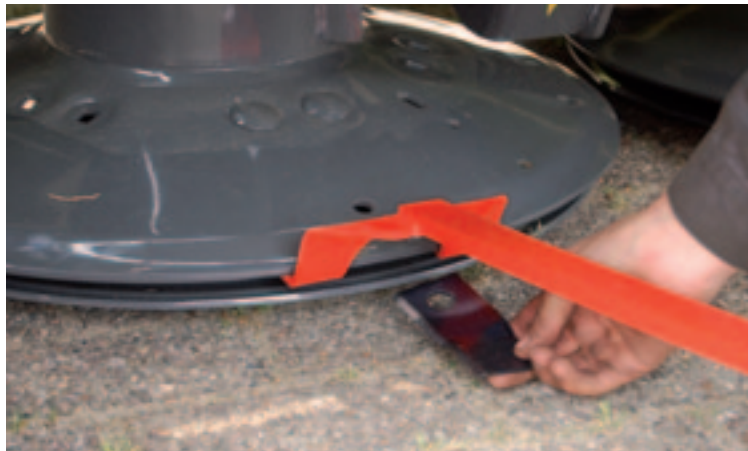
Bij de Corto-trommelmaaier van Claas gebeurt de mesjeswissel met een vorkhefboom; die handeling heb je snel onder de knie. Het is wel zaak de omgeving van de pen goed schoon te houden. Een tweezijdig maaierend mesje voor de Corto kost 1,13 euro excl. btw. De veerplaat met de mespen komt op 95,71 euro.
