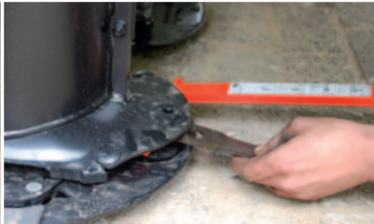
De hefboom bij de Claas-schijvenmaaier past er van beide zijden tussen en drukt de veerplaat naar beneden. Je moet met die enkelzijdige hefboom de eerste keren even de juiste plek weten te vinden. De pen zit op de veerplaat. Bij slijtage zijn ze samen aan vervanging toe. Een mesje voor de Disco komt op 1,30 euro.
