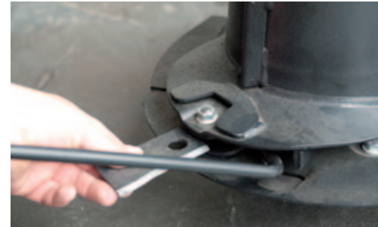
De hefboom bij de schijvenmaaier van BCS past er zowel van links als van rechts tussen. De handeling is eenduidig; er zijn weinig misverstanden mogelijk. De hefboom is op te bergen in een holle framebuis. Bij de trommelmaaiers van BCS zit de hefboom voor de mesjeswissel in een houder.
