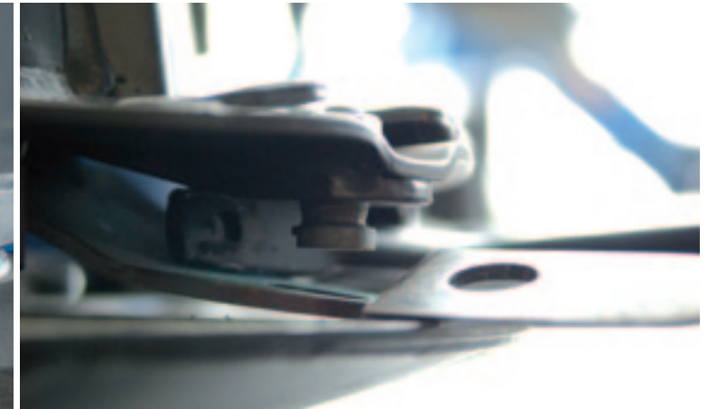
De hefboom drukt bij BCS de veerplaat naar beneden, waarna het mes naar beneden van de pen af te halen is. Die pen is bij slijtage als los onderdeel te vervangen en kost compleet 12,04 euro. Importeur ZHE brengt voor een doosje mesjes met 20 stuks 38 euro in rekening. Een los mesje kost 2,50 euro.
