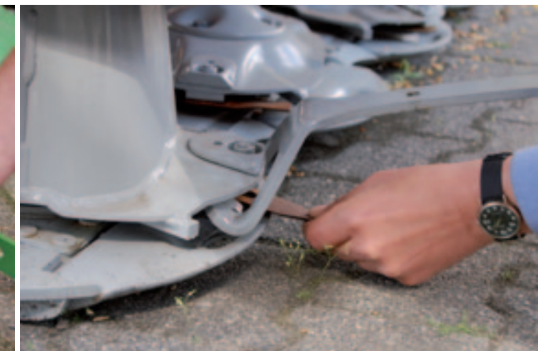
SIP is één van de weinige merken die bij de schijvenmaaier een vorkhefboom toepast. Dat geeft bij de wissel een solide gevoel. De hefboom drukt alleen de veerplaat naar beneden. De pen die het mesje vasthoudt, is als slijtdeel apart te vervangen en kost 6,04 euro excl. btw. Voor een mesje brengt importeur Zonna 1,76 euro in rekening.
