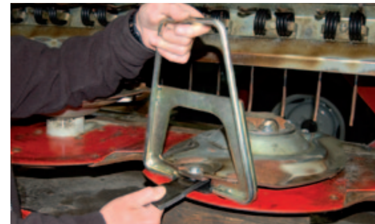
De schijvenmaaiers van Fella hebben af-fabriek een mesbevestiging met een bout; de dealers vervangen die bij de aflevering door een snelwisselsysteem. De mespen (mesbout) is afzonderlijk te vervangen en kost met moer 6,98 euro. Een mesje kost 1,91 euro. De hefboom van Fella kan in z'n dode punt zelfstandig rechtop staan zonder het risico dat hij omklapt.
