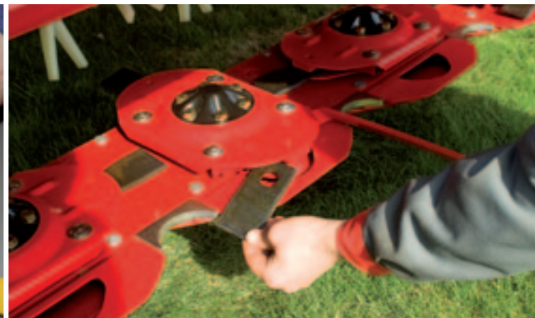
De hefboom van de JF-Stoll schijvenmaaier moet er vanaf de rechterkant in. Hij drukt de veerplaat met daarop de mespen naar beneden. Bij slijtage worden beide delen vervangen. Het mesje kan er alleen overdwars op en af. De kans dat het spontaan 'vrijkomt' is nagenoeg nul. Een mesje kost bij JF-Stoll 3,50 euro.
