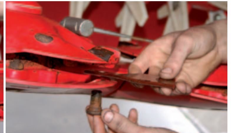
Lely hanteert voor een 120 mm mesje (met twee snijkanten) een adviesprijs van 1,81 euro exclusief btw per stuk op basis van een doosje van 24. Voor de veiligheid adviseert Lely om tegelijk met een mesjeswissel ook de borgclip te vervangen. Die kost 1,12 euro exclusief btw. Een mespen kost 4,35 euro.
