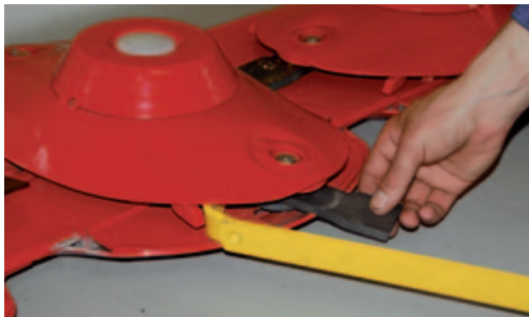
Bij de schijvenmaaier van Pöttinger kan de hefboom er van beide zijden in. Hij drukt de veerplaat naar beneden, waarna het mesje naar onderen toe van de pen te halen is. Die penbout is afzonderlijk te vervangen en kost bij Duport 6,53 euro. Een mesje kost 1,36 euro. Pöttinger heeft ook trommelmaaiers in het gamma.
