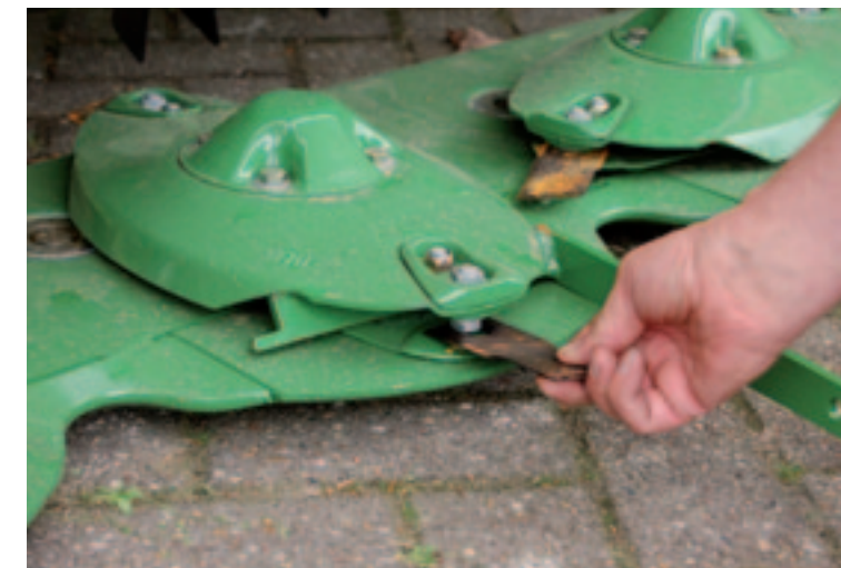
De Krone-hefboom drukt de veerplaat naar beneden, waarna de pen vrijkomt die het mes op z'n plaats houdt. Deze pen is afzonderlijk te vervangen en kost bij Krone compleet 2,75 euro excl. btw. Een mesjes kost 1,38 euro. De hefboom voor de mesjeswissel steunt af op beide zijden van de schijf; dat maakt de beweging vrij voorspelbaar.
