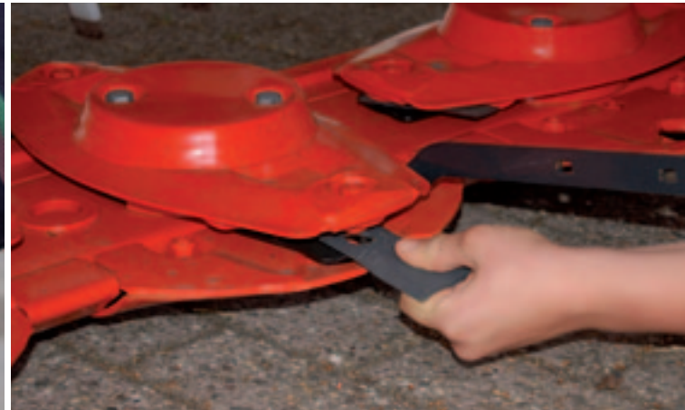
De hefboom voor de Kuhn schijvenmaaier is ongecompliceerd en past er zowel vanaf links als van rechts in. Hij drukt de veerplaat naar beneden met daarop de pen die het mesje vasthoudt. Als de pen slijtage vertoont moet deze samen met de veerplaat vervangen worden; dat kost 19,33 euro. Een mesje kost 1,23 euro.
