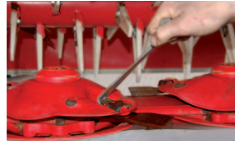
Lely heeft als enige een mesjeswissel die geen kracht vraagt. Een kort hefboompje wipt een borgclip los, waarna de pen er met het hamertje (de andere zijde van het hefboompje) uit te tikken is of er vanzelf al uitvalt. De wissel is bij Lely geen werk waar je tegenop kunt zien.
