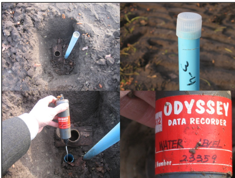
Figuur 90 'Odyssey' voor het meten van diepe (3,5 m-mv) grondwaterstanden (11 stuks) tijdens de beginperiode van de metingen, voordat de ombouw naar drie meetblokken plaatsvindt (plaatsing op 13 oktober 2008).
