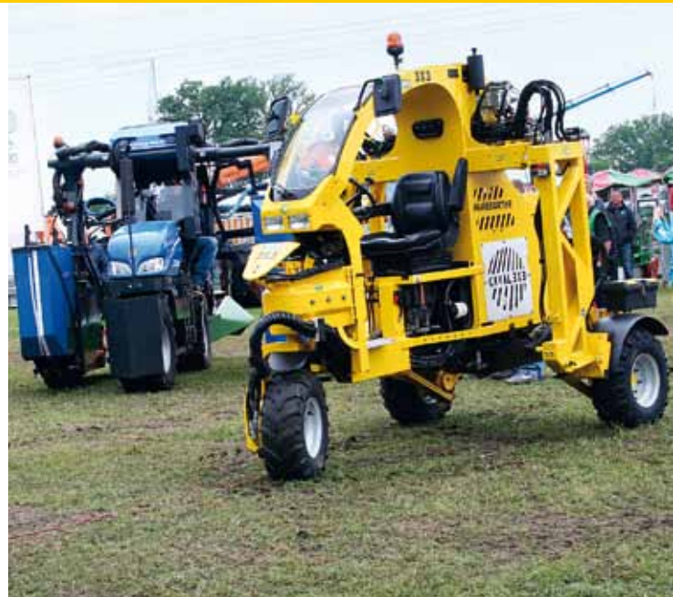
Caval, kleine variant van een GRV-portaaltrekker, weegt slechts 1,2 ton.
