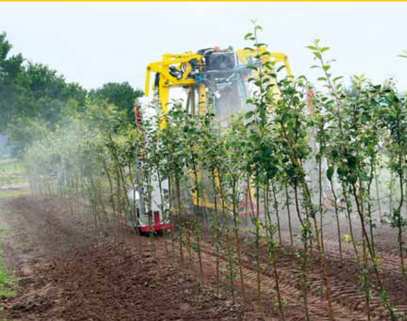
De portaaltrekker Arbor-Rex met een spuit op de testlocatie aan het werk.
