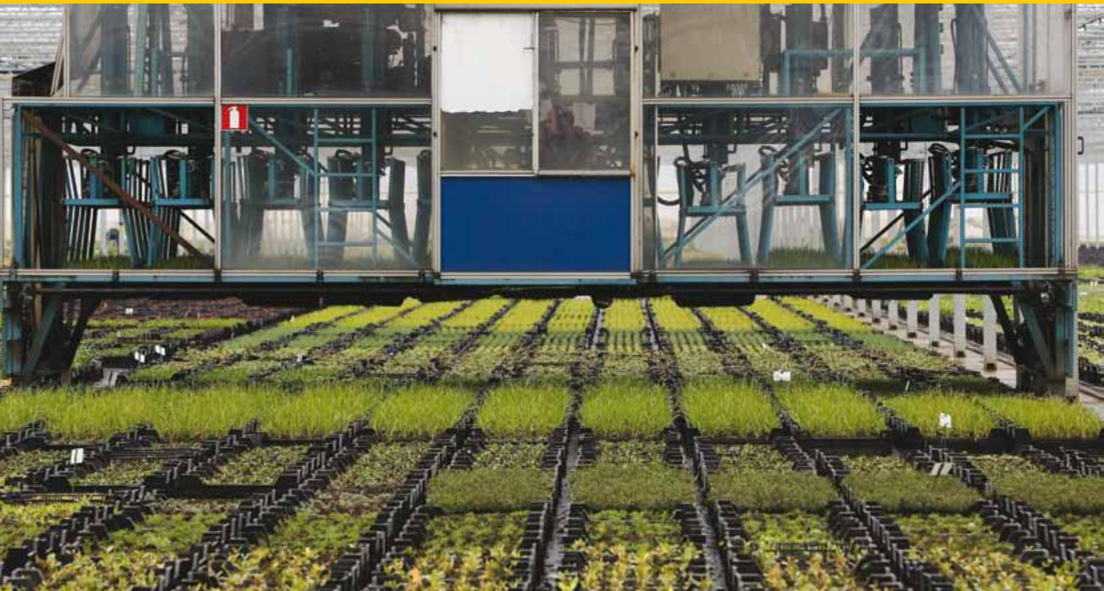
De plantenrobot is feitelijk de centrale spil van het bedrijf. Hij brengt en haalt alle planten van de oppotlijn naar het containerbed en uiteindelijk naar de distributiehof. De machine kan in één keer 66 kratten oppikken
