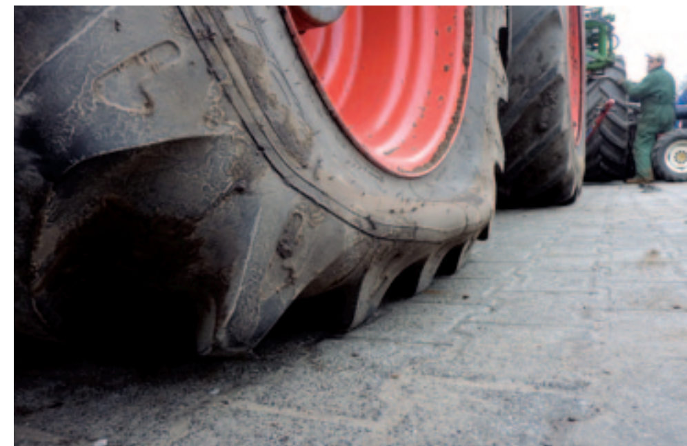
▲ Op basis van recent onderzoek door het Franse instituut IRSTEA claimt Michelin dat de bodemdruk onder een IF-band met een spanning van 1,4 bar lager kan zijn dan onder een rupsband.
