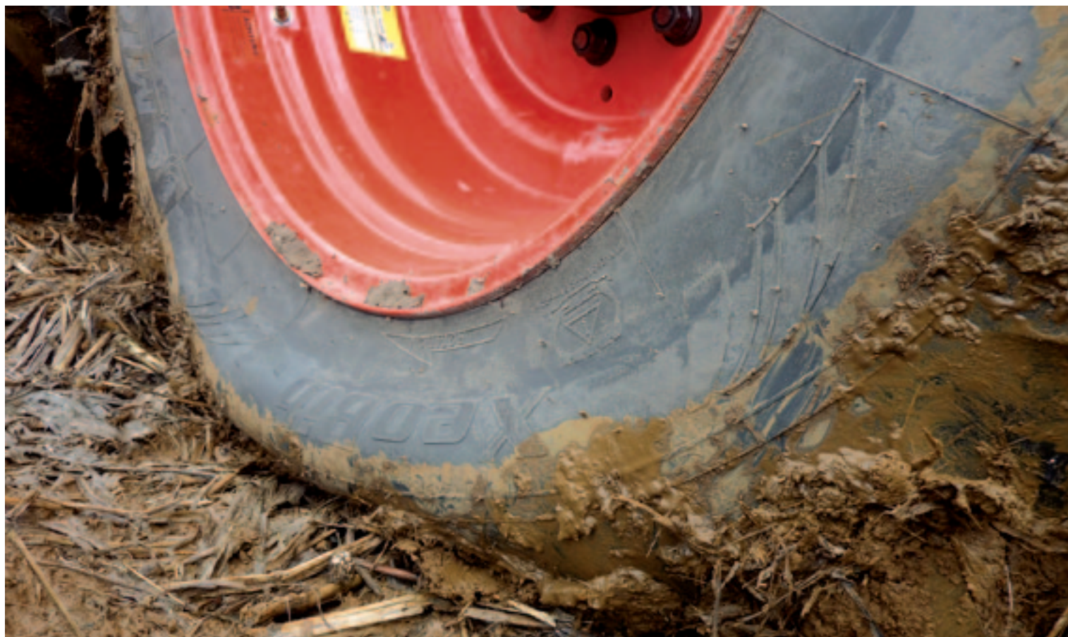
▲ De XeoBib kan in de flank ver doorbuigen zonder dat het karkas daaronder lijdt. De band verlengt zo bij het toenemen van de aslast zijn loopvlak. De druk op de bodem neemt daardoor niet noemenswaardig toe. Bij insporen van de nokken (zoals hier) neemt het contactoppervlak in de breedte ook iets toe.
