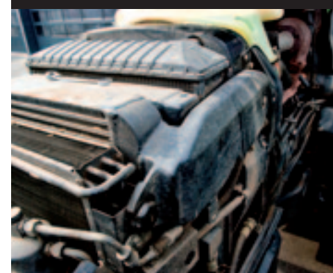
▲ Een vernauwing in de luchttoevoer zorgt voor een trage luchtstroom.
