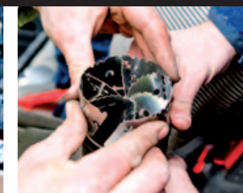
▲ De metalen plaatjes van de cycloon die als een wokkel zijn gevormd, geven de inlaatlucht een draai, zodat die door de slangen kolkt.
