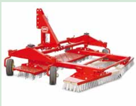
Naam: SMG Decompacteer borstel DC1600 Leverancier: Rooden Landscape Solutions Afmetingen: L 1267 x B 1677 x H 425 mm Gewicht: 130kg Aandrijving: Voortgetrokken borstel in V-vorm Werkbreedte: 1400 mm Werkdiepte: 6 rijen, 100mm lange stalen pennen
