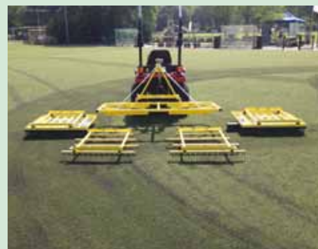
Naam: Bristly 2.0 combi Leverancier: Rolugro Aandrijving: voortgetrokken Werkbreedte: 1200 mm
