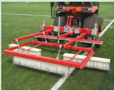
Naam: Verti-Groom Leverancier: Redexim Gewicht: 225 kg Aandrijving: voortgetrokken, 18PK Werkbreedte: 2000 mm Werkdiepte: 0 – 30 mm
