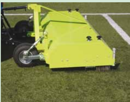
Naam: Rake Master Leverancier: AT Machines Afmetingen: L 1200 x B 1820 x H 500 mm Aandrijving: Voortgetrokken, 30 PK Werkbreedte: 1800 mm
