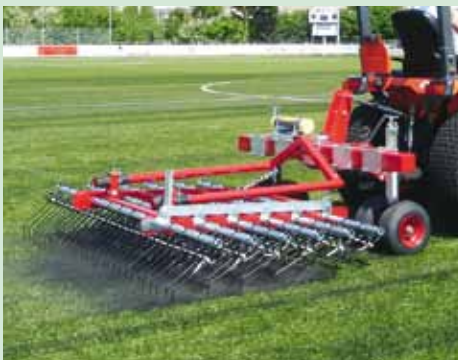
Naam: Verti-Rake Leverancier: Redexim Gewicht: 175- 550 kg Aandrijving: voortgetrokken Werkbreedte: 2900 - 6000 mm Werkdiepte: verstelbaar
