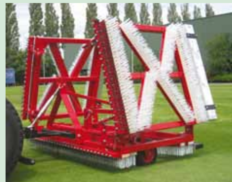
Naam: Verti-Comb Leverancier: Redexim Gewicht: 140 - 220 kg Aandrijving: voortgetrokken Werkbreedte: 1800 4000 mm Werkdiepte: verstelbaar
