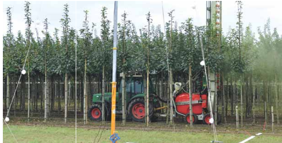
De driftreductie van de mastspuit met sensoren is zo groot, dat deze techniek in aanmerking kan komen voor een kleinere teeltvrije zone.
