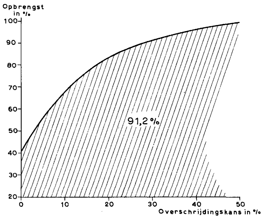
Fig. 13. Voorbeeld van de relatie tussen opbrengst in % voor wintertarwe (korrel) en kans van optreden bij een voorjaarsgrondwaterstand van 0,80 \text{ m m.v.} en een zomergrondwaterstand van 1,42 \text{ m m.v.}
