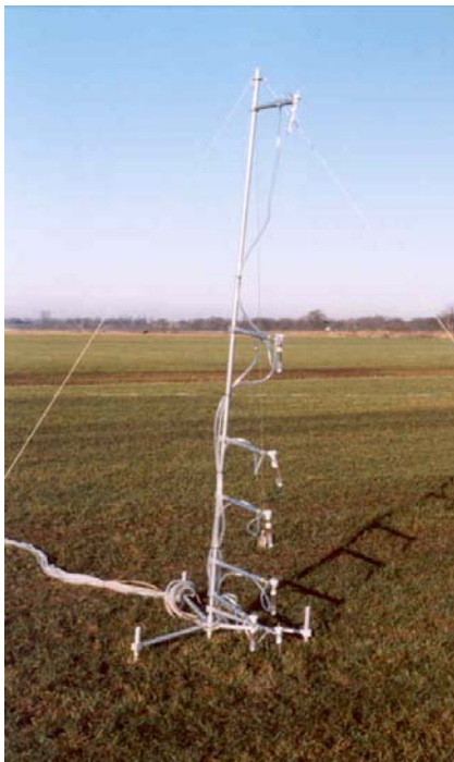
Centrale meetmast met 7 meetpunten met daarnaast één meetpunt (een gaswasfles met absorptievloeistof met impinger).
