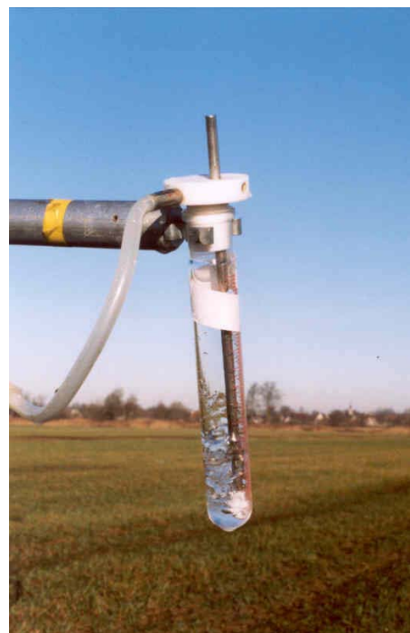
Centrale meetmast met 7 meetpunten met daarnaast één meetpunt (een gaswasfles met absorptievloeistof met impinger).
