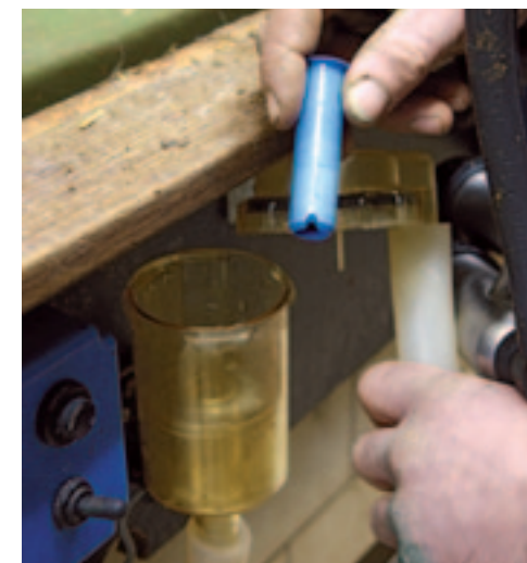
Het gleufje in het pijpje van de melkstream-indicator is iets groter dan gangbaar.
