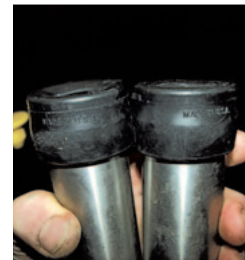
De melkbekervoering bevat geen grafiet.
