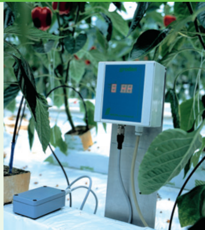
Uit metingen blijkt dat het watergehalte flink kan variëren afhankelijk van de plaats van het draingat.
