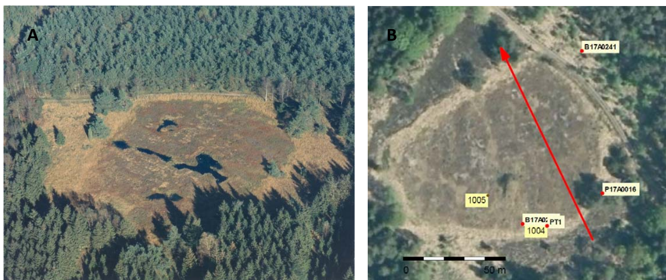
Figuur 5.15.3 Luchtfoto's van Poort 2. A. 23 oktober 1990 (KLM Luchtfotografie Schiphol), B. Ligging van peilbuizen en dwarsdoorsnede (rode lijn) in Poort 2 (Von Asmuth e.a. 2010). Het open water is in 30 jaar tijd bijna verdwenen.
