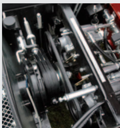
Links onder het rooster zit een flexibele koppeling om trillingen op te vangen, rechts daarvan de elektrisch bediende koppeling voor de drie v-snaren die het maaidek aandrijven. Rechts zitten de hydrostaten.
