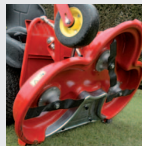
Bijzonder is dat je het maaidek van de Gianni Ferrari TurboZ steil omhoog kunt zetten. Daardoor is het heel eenvoudig om het maaidek schoon te maken of om onderhoud uit te voeren.
