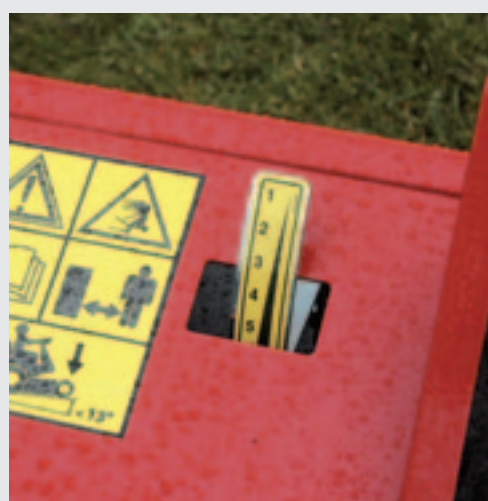
Komt het maaidek in maaipositie, dan komt een schaalverdeling tevoorschijn. Na het heffen van het maaidek moet je die wel elke keer weer even instellen.
