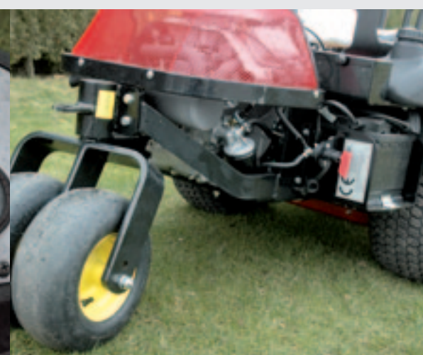
Rechts de accu en een massaschakelaar. Boven het wiel de brandstoftank die is verbonden met zo'n zelfde tank aan de linkerzijde. Een enkel achterwiel of de wielen verder uit elkaar plaatsen, is een optie.
