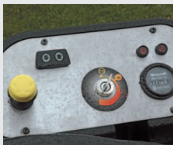
Starten en rijden. Links de gele knop om het maaien in- en uit- te schakelen. Bovenin de schakelaar om het maaidek te laten heffen of zakken.
