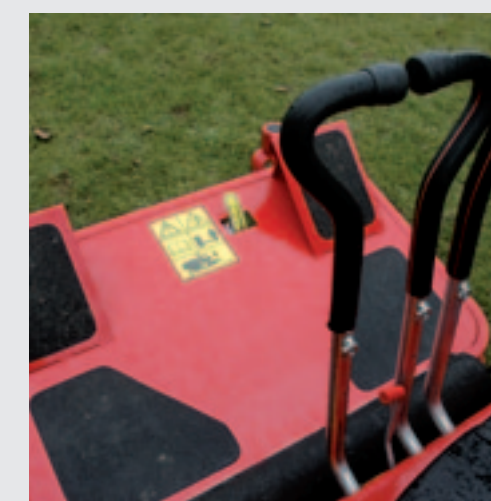
Sturen vergt een beetje handigheid. Met één hand bedien je de grote rijkhendel op rechts, met de andere hand bedien je de beide stuurhendels.
