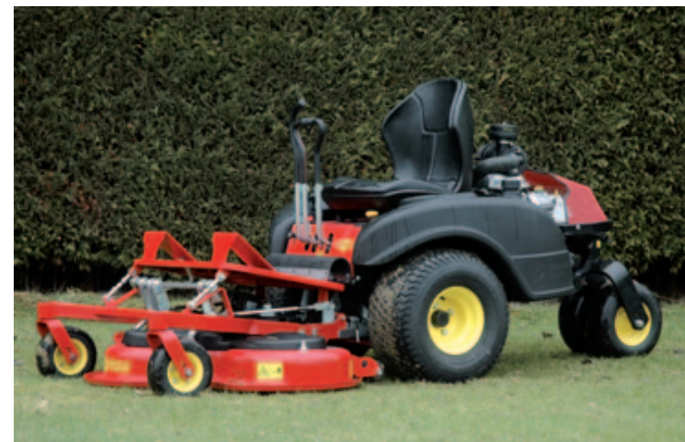
De TurboZ is een echte Zeroturn machine en kan om de kleinste cirkel draaien. Bovendien is het een typische frontmaaier. Ergonomisch gezien is de zitpositie wat laag.
